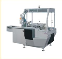
洗練されたロータリータイプのチューブ充填機
